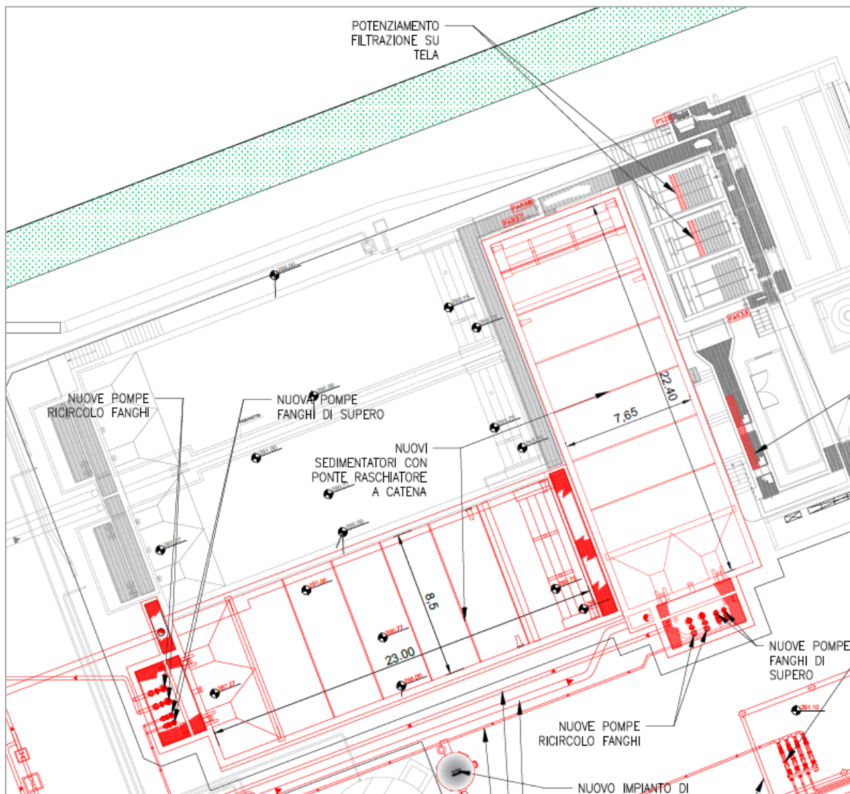
Figura 5-13 - Stralcio della planimetria delle vasche di sedimentazione, unità di filtrazione su tela e di disinfezione UV
