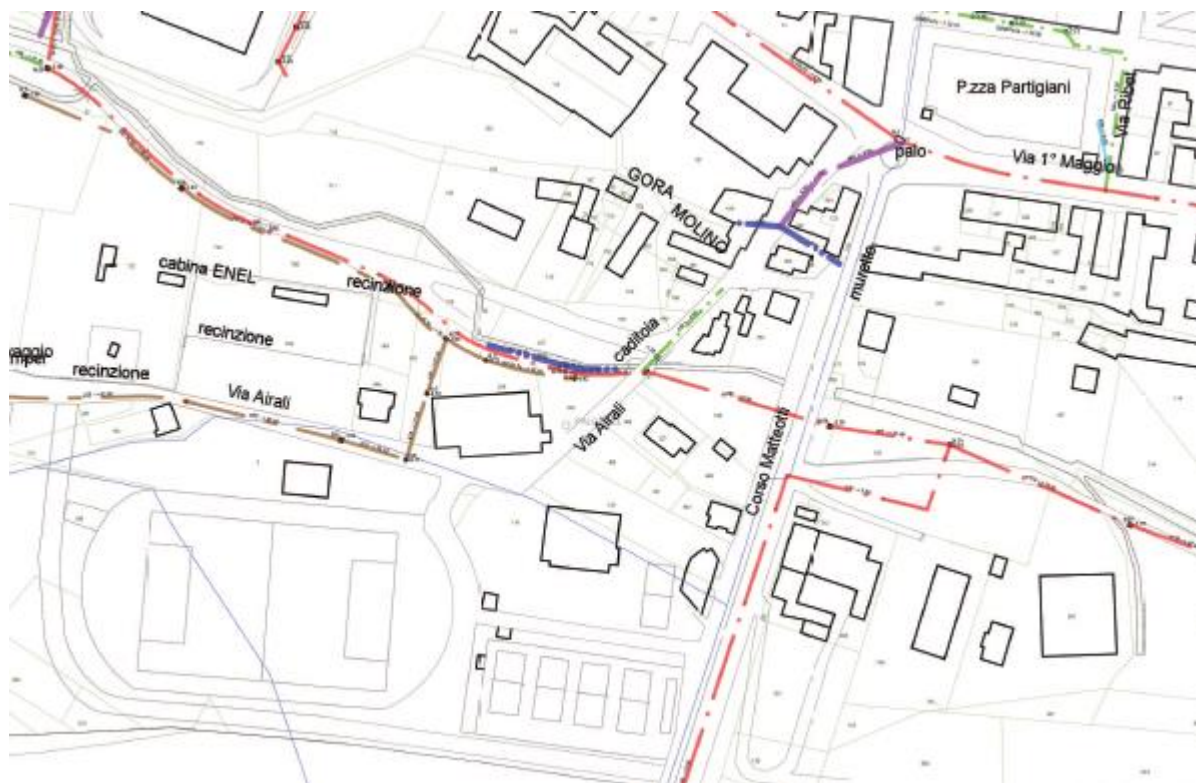
Figura 5-5 - Planimetria del sistema fognario terminale di Luserna. Il collettore marrone costituisce il recapito finale del collettore in progetto
