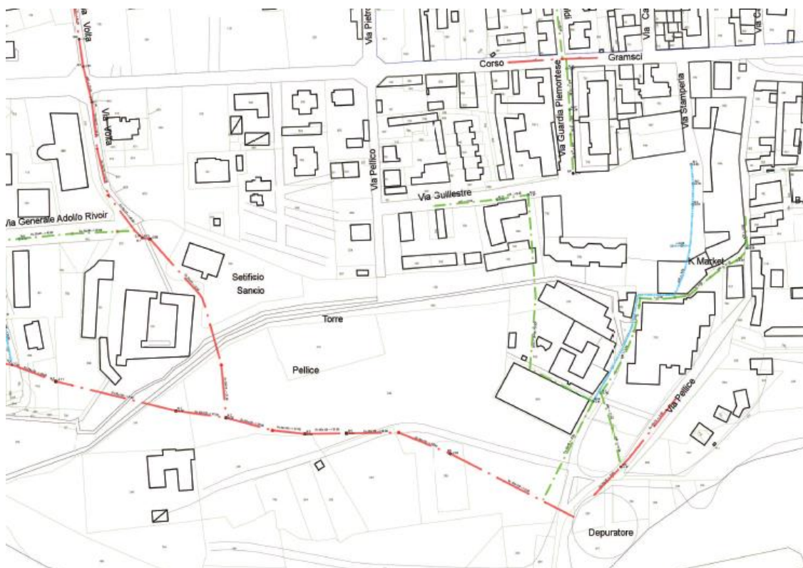
Figura 5-3 - Planimetria del sistema fognario terminale di Torre Pellice
